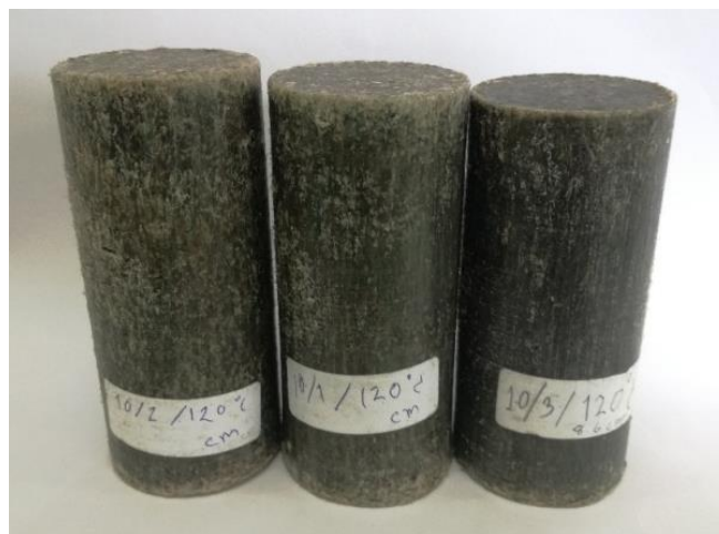
ภาพที่ 3 ก้อนตัวอย่างขึ้นรูปที่อุณหภูมิ 120 องศาเซลเซียส แรงขึ้นรูป 10 กิโลกรัมต่อตารางเซนติเมตร ระยะเวลา 5 นาที
