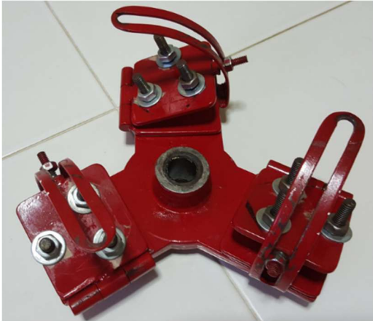
รูปที่ 2 อุปกรณ์สำหรับปรับมุมพิทช์ของใบกังหันลมที่ติดตั้งกับคัมของกังหันลม
