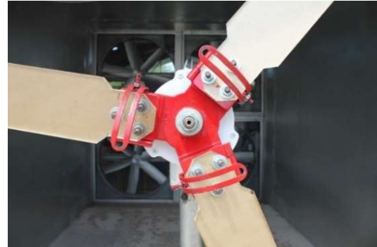
รูปที่ 4 ใบกังหันลมที่ติดตั้งอุปกรณ์สำหรับปรับมุมพิทช์ของใบกังหันลมอะคลิลิก
