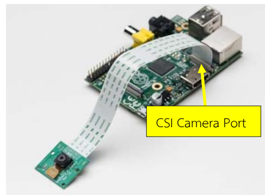
รูปที่ 6 Raspberry Pi camera board [13]
