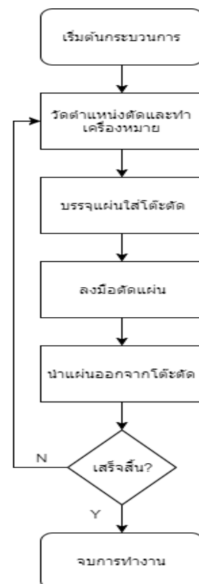
รูปที่ 3 กระบวนการตัดแผ่นอลูมิเนียมคอมโพสิตด้วยเลื่อยวงเดือน
