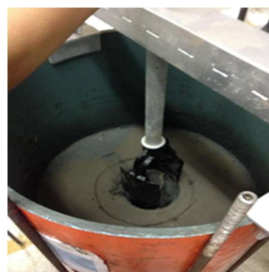
รูปที่ 4 การเจาะดินเพื่อทำเสาเข็มดินซีเมนต์
