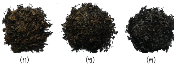
รูปที่ 4 ถ่านทอร์รีไฟด์ที่เวลาคงอยู่ของของแข็ง (ก) 1 (ข) 3 และ (ค) 5 นาที โดยอุณหภูมิคงที่ที่ 280 องศาเซลเซียส
