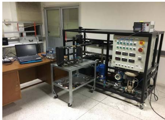
รูปที่ 3 ชุดทดลองการวิเคราะห์สมรรถนะเชิงความร้อนของอุปกรณ์แลกเปลี่ยนความร้อนแบบแผ่น
