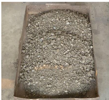
รูปที่ 1 RAP ไม่ผ่านกระบวนกรคัดแยกขนาด
