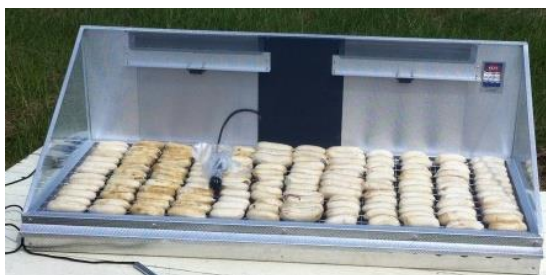
รูปที่ 15 การทดลองตูอบแห้งพลังงานแสงอาทิตย์แบบติดตั้งอยู่กับที่
