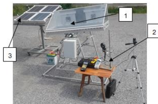
รูปที่ 4 การจัดวางอุปกรณ์ที่ใช้ในการทดลองหาสมรรถนะของตู้อบแห้งคล้อยตามแสงอาทิตย์
