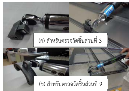
รูปที่ 5 การติดตั้งอุปกรณ์ช่วยตรวจวัดและการตรวจวัดความแข็งแรงจุดเชื่อม
