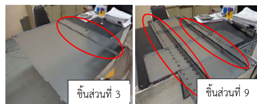
รูปที่ 2 ตำแหน่งที่ต้องตรวจวัดความแข็งแรงจุดเชื่อมต่อ
