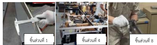
รูปที่ 3 วิธีการตรวจวัดชิ้นส่วนด้วยเวอร์เนียสคาร์ลิปเปอร์
