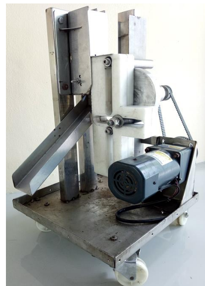
ค) เครื่องแกะเมล็ดบัวหลวงต้นแบบ
