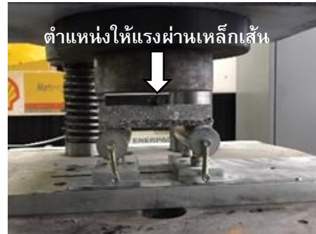
รูปที่ 5 การติดตั้งตัวอย่างทดสอบโมดูลัสแตกร้าว
