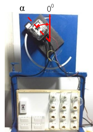
(ค) ลักษณะมิเตอร์ไฟฟ้าแบบเหนี่ยวนำทำมุมเอียงข้าง ( \alpha )
