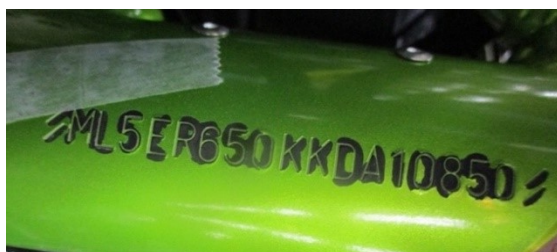
รูปที่ 2 ลักษณะข้อบกพร่องประเภทสีแตกของชิ้นส่วนรถจักรยานยนต์
