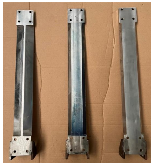
รูปที่ 11 ใบมีดที่ใช้ในการทดสอบ ที่มีมุมใบมีดต่างกัน
