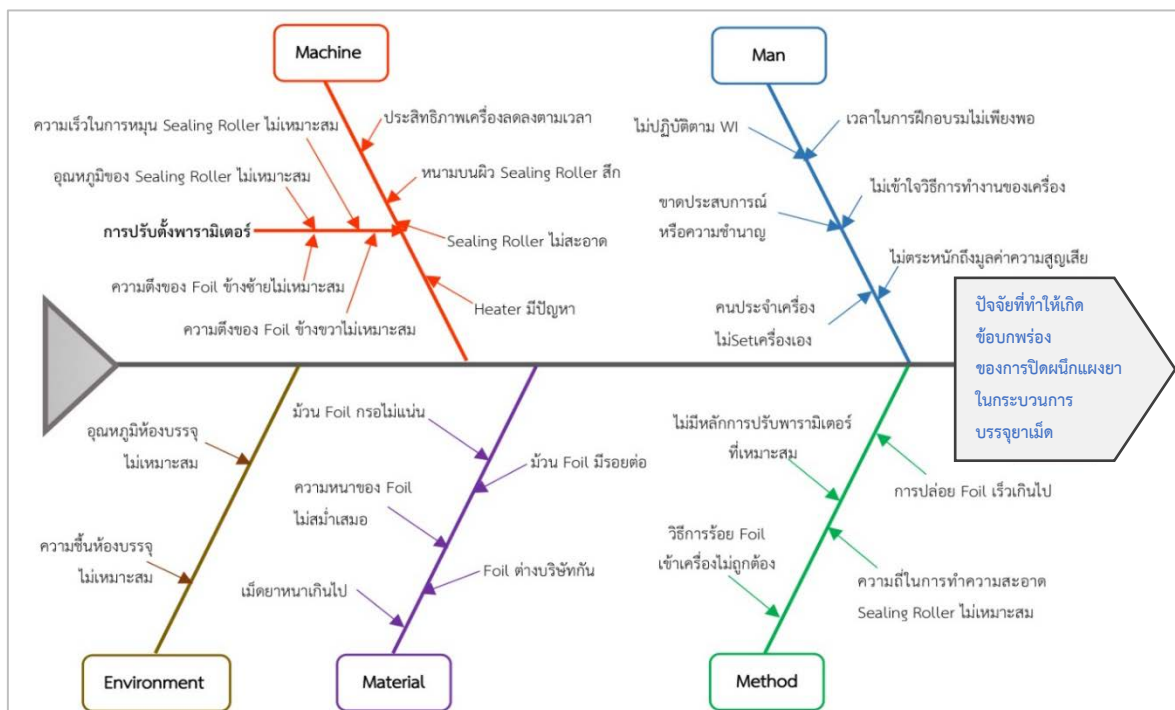
รูปที่ 6 แผนภาพแสดงการวิเคราะห์สาเหตุของข้อบกพร่องประเภทแผงปิดผนึกไม่สมบูรณ์
