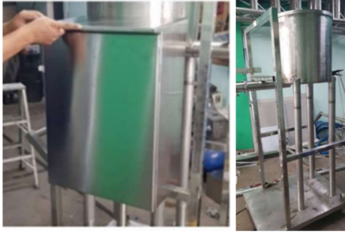
รูปที่ 7 ประกอบเครื่องบรรจุน้ำซูป
