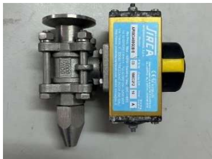
รูปที่ 8 ประกอบ Control valve กับ Ball valve
