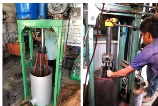
รูปที่ 6 การอัดเตาชีวมวลทรงกระบอก
