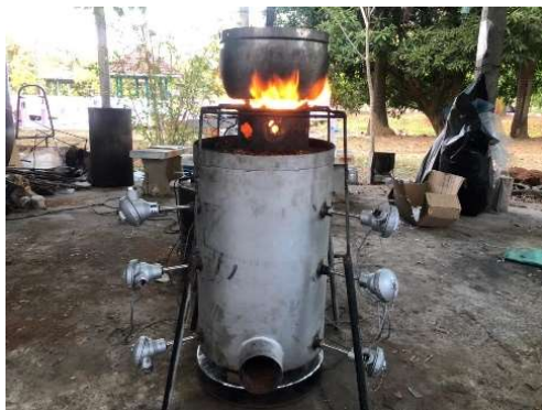
รูปที่ 8 การติดตั้งเครื่องมือทดลองหาประสิทธิภาพเชิงความร้อนด้วยวิธีการ Water boiling test
