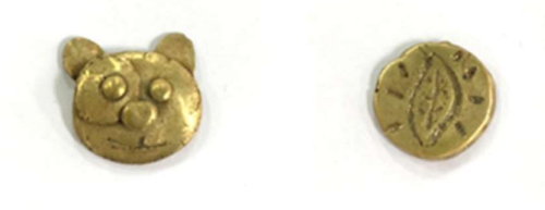
รูปที่ 24 ตัวอย่างชิ้นงานบราซเคลย์ที่ขึ้นรูปโดยการปั้น
