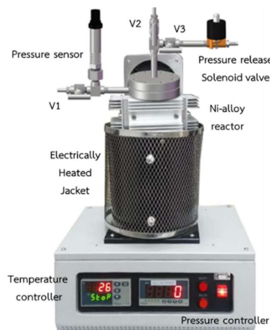
รูปที่ 3 เครื่องปฏิกรณ์ไฮโดรเทอร์มัลลิคิตแพคชั่น
