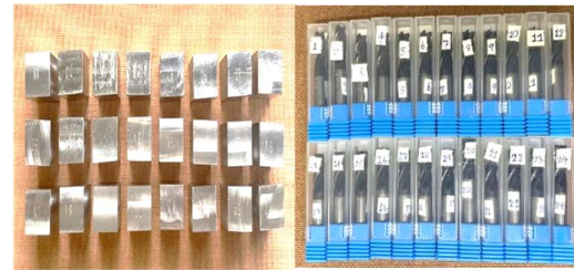
รูปที่ 2 วัสดุที่ใช้ในการทดลอง เหล็กกล้าเครื่องมือ JSI SKD61 และดอกเอ็นมิลคาร์ไบด์
