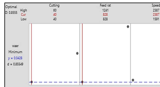
รูปที่ 6 ค่าพารามิเตอร์ที่เหมาะสมในการทดลองการกัดเหล็กกล้า SKD61
