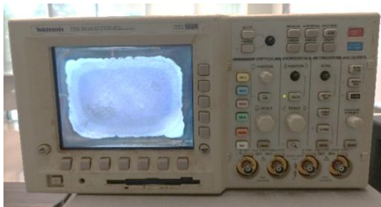
รูปที่ 2 หน้าจอแสดงผลแบบแอลซีดีเสื่อมสภาพ
