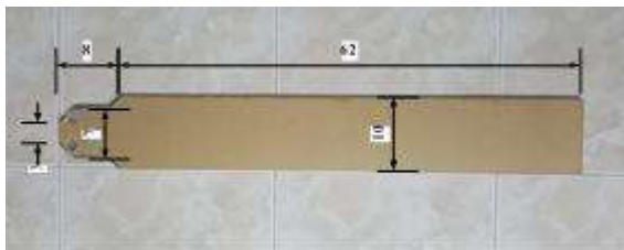
รูปที่ 3 ใบกังหันลมอะคลิลิก (หน่วย เซนติเมตร)
