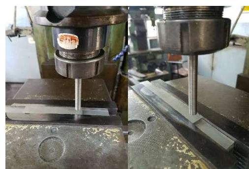
รูปที่ 4 ลักษณะการจับยึดชิ้นงานทดลองเชื่อม
