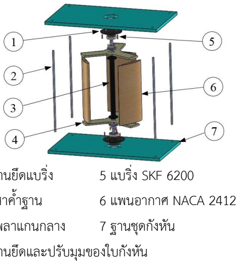
รูปที่ 6 ชุดกังหันลมแกนตั้งแบบ 3 ใบกังหัน
