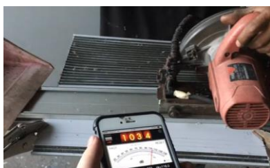
รูปที่ 5 วัดระดับเสียงที่เกิดขึ้นจากการตัด โดยใช้แอปพลิเคชัน SPLnFFT ผ่านโทรศัพท์เคลื่อนที่
