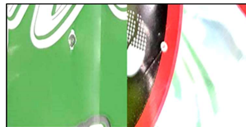
รูปที่ 2 ลักษณะข้อบกพร่องประเภท (ก) เจลดำ และ (ข) เจลใส
