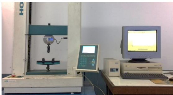
รูปที่ 3 เครื่องทดสอบสากลยี่ห้อ Hounsfield
