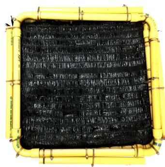
รูปที่ 1 แผ่นตัวกลางที่ใช้ในการเพาะเลี้ยงสาหร่ายขนาดเล็กในระบบตรึงฟิล์ม
