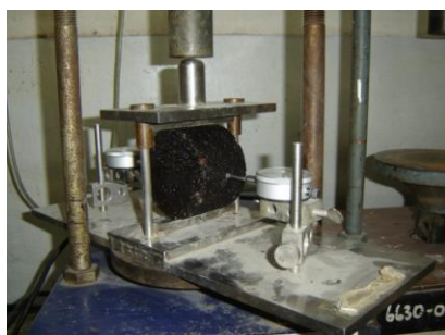
รูปที่ 3 การทดสอบความต้านทานต่อแรงดึงทางอ้อม
