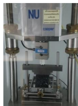
รูปที่ 4 การทดสอบค่าโมดูลัสคืนตัว
