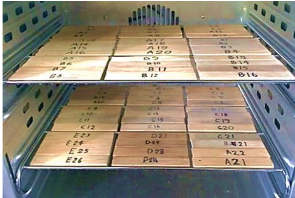
รูปที่ 2 ชิ้นทดสอบไม้ไผ่ที่ผ่านการอบแห้ง
