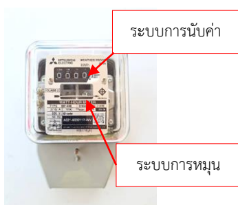
(ก) ลักษณะด้านหน้าของมิเตอร์ไฟฟ้าแบบเหนี่ยวนำ
