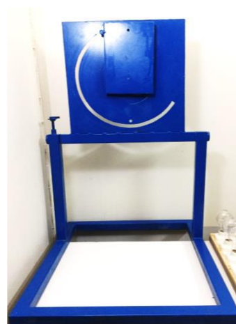
รูปที่ 2 แท่นทดลองที่สามารถปรับองศาการติดตั้งมิเตอร์ไฟฟ้าแบบเหนี่ยวนำได้ และเอียงข้าง ( \alpha ) ได้
