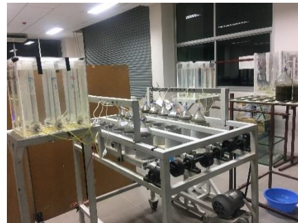
รูปที่ 1 ชุดทดลองหาศักยภาพการผลิตก๊าซชีวภาพ
