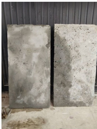
รูปที่ 10 ตัวอย่างมอร์ตาร์ที่ผ่านการทดสอบการซึมผ่านน้ำ
