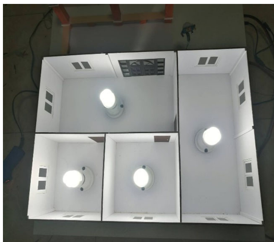
รูปที่ 17 การทดสอบการเปิด-ปิดหลอดไฟผ่านแอปพลิเคชัน Blynk
