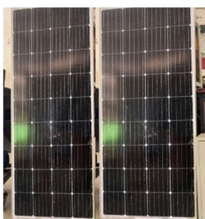
รูปที่ 12 แผงโซลาร์เซลล์ขนาด 450 วัตต์ 12 โวลต์
