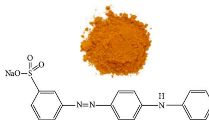
รูปที่ 2 ลักษณะทางกายภาพและโครงสร้างทางเคมีของสีย้อมเหลืองแอซิด 36
