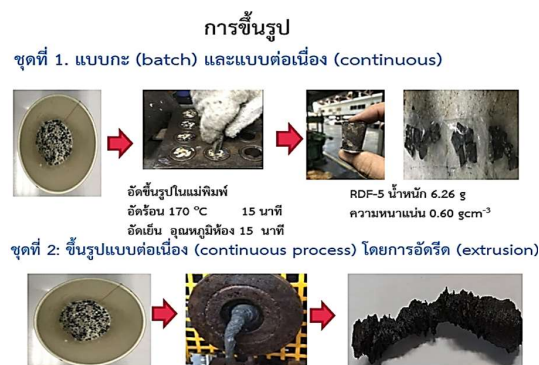
รูปที่ 3 กระบวนการผลิต RDF-5 ในระดับห้องปฏิบัติการแบบกะ (Batch) และแบบต่อเนื่อง (continuous)
