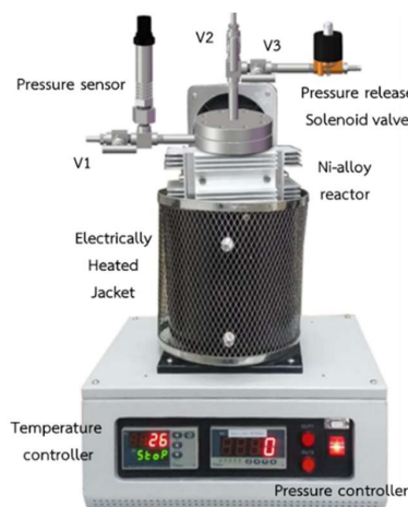
รูปที่ 3 เครื่องปฏิกรณ์ไฮโดรเทอร์มัลลิควิดแฟกชัน
