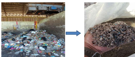
รูปที่ 2 (ซ้าย) ขยะท้ายรางที่ใช้ในการทดลอง (ขวา) ขยะที่ ถูกบด ก่อนนำไปผสมกับยางพาราเพื่อผลิตเป็น RDF-5
