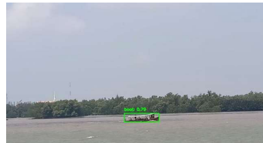
รูปที่ 9 การตรวจจับภาพเรือด้วย Faster R-CNN
