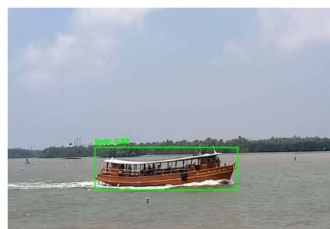
รูปที่ 10 การตรวจจับภาพเรือด้วย Faster R-CNN
