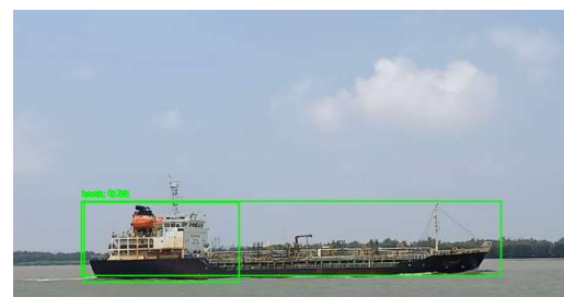
รูปที่ 12 การตรวจจับภาพเรือด้วย SSD
