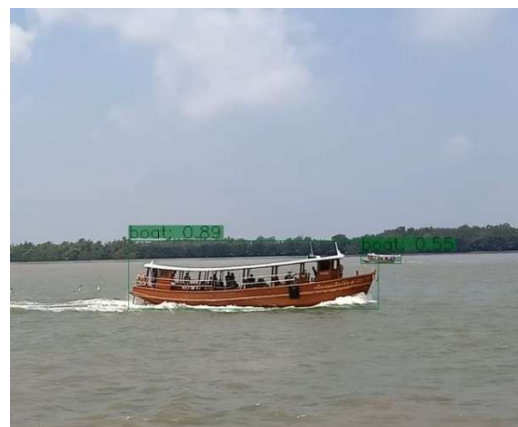
รูปที่ 3 การตรวจจับภาพเรือด้วย YOLOv7
