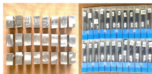
รูปที่ 2 วัสดุที่ใช้ในการทดลอง เหล็กกล้าเครื่องมือ JSI
