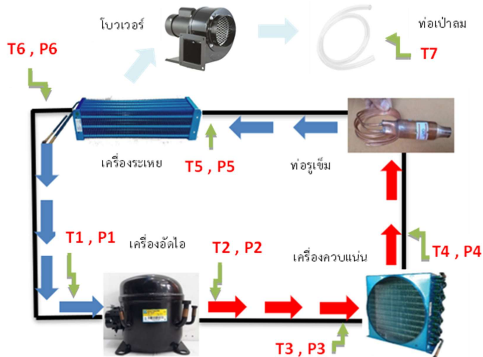
รูปที่ 1 ส่วนประกอบของระบบและจุดวัดอุณหภูมิและความดัน
