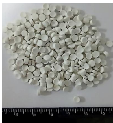
รูปที่ 20 มวลรวมเศษขยะพลาสติก PVC ที่ใช้ในการ ก่อสร้างทางจักรยานตัวอย่างขนาดเล็ก
