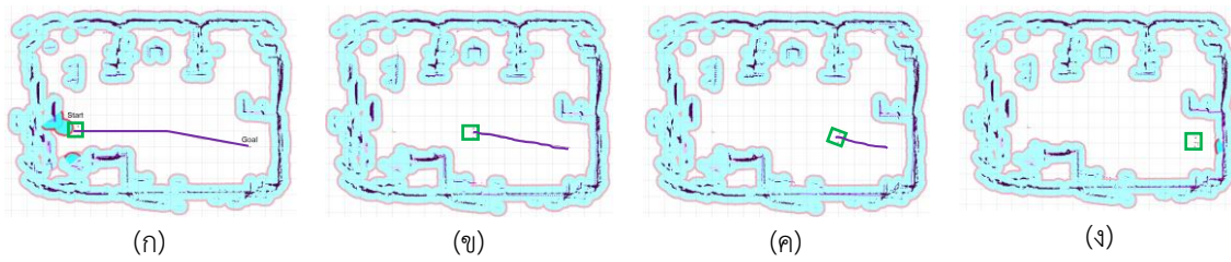
รูปที่ 9 เส้นแนวทางการเดินของหุ่นยนต์จากการทดลองนำทางในพื้นที่โล่ง โดยเริ่มจากรูป 9 (ก) ไปยัง 9 (ง)
