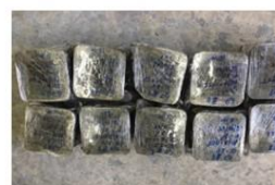
Figure 1. จีโอโพลิเมอร์คอนกรีตในแบบหล่อ และหุ้มด้วยพลาสติกกันน้ำ
