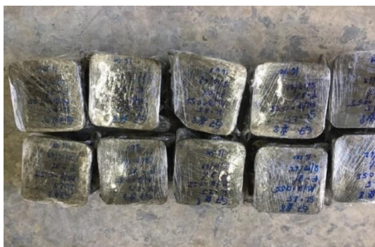
ภาพที่ 2 ตัวอย่างจีโอโพลิเมอร์คอนกรีตในแบบหล่อ และหุ้มด้วยพลาสติกแผ่นบาง
