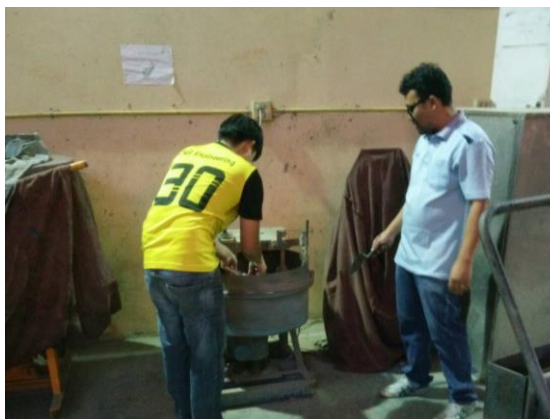
ภาพที่ 1 การผสมจีโอโพลิเมอร์คอนกรีตในเครื่องผสมคอนกรีต
