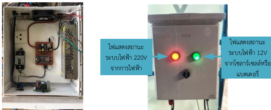
ภาพที่ 4 ตัววงจรระบบควบคุมอุโมงค์ฆ่าเชื้อไวรัสร่วมกับอินเทอร์เนตของสรรพสิ่ง
