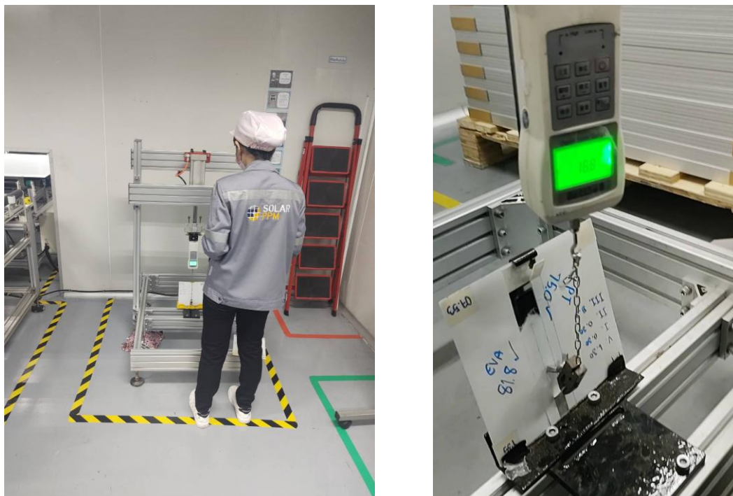
ภาพที่ 6 ทดสอบการทำงานของเครื่องทดสอบแรงดึงต้นแบบโดยแผนก QC ของบริษัท
