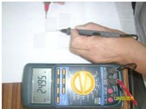
(ข) แสดงการทดสอบด้านที่เป็นกระจกเคลือบสาร ITO
