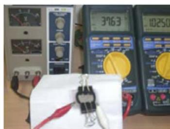
(ข) แรงดันไบอัส 1.025 V และกระแส 37.63  $\mu$ A
