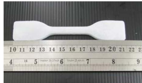
รูปที่ 5 ตัวอย่างชิ้นงานที่ขึ้นรูปด้วยวิธีการเทหล่อ
