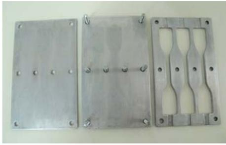
รูปที่ 3 แม่พิมพ์สำเร็จสำหรับการเทหล่อขึ้นรูป
