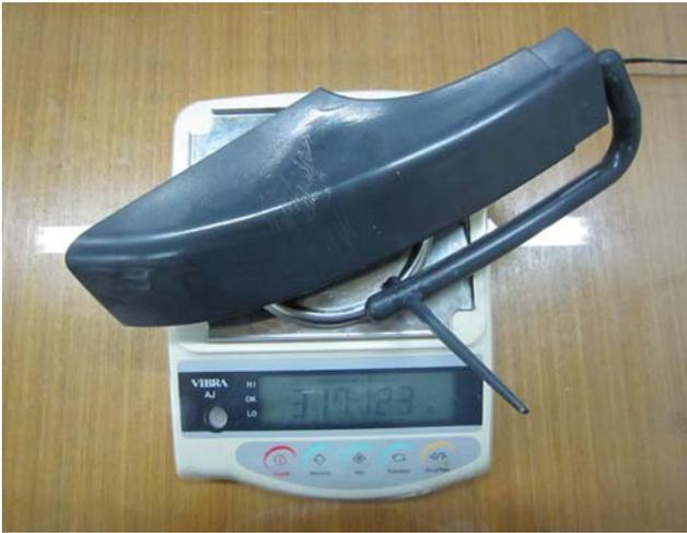
รูปที่ 15 การชั่งชิ้นงานเพื่อหาน้ำหนักหลังใช้ก๊าซช่วยฉีด (317.123 กรัม)
