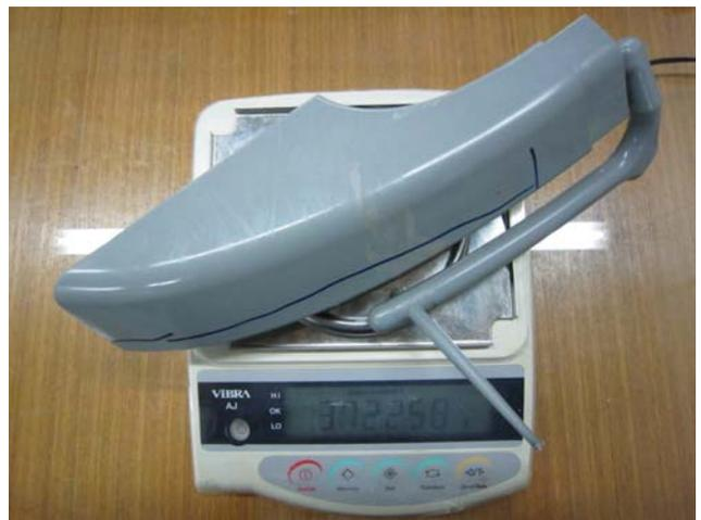
รูปที่ 14 การชั่งชิ้นงานเพื่อหาน้ำหนักก่อนใช้ก๊าซช่วยฉีด (372.258 กรัม)
