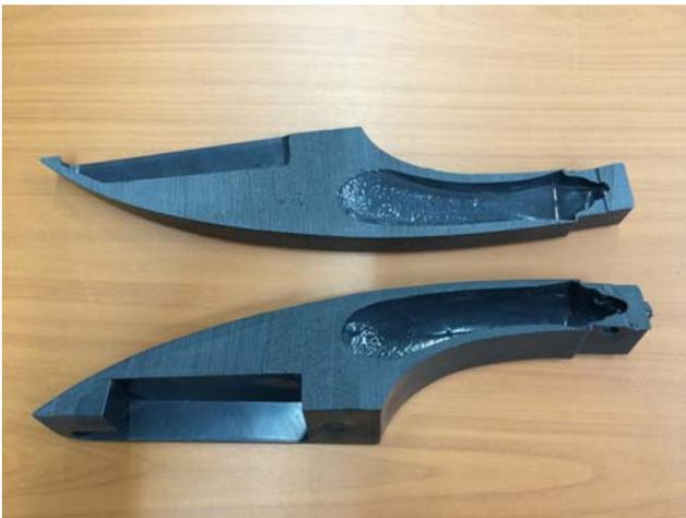
รูปที่ 16 แสดงลักษณะการไหลของก๊าซภายในชิ้นงาน
