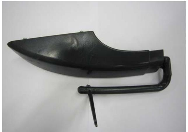
รูปที่ 13 ชิ้นงานหลังการปรับฉีดที่มีความสมบูรณ์ที่สุดที่ได้จากการทดลอง
