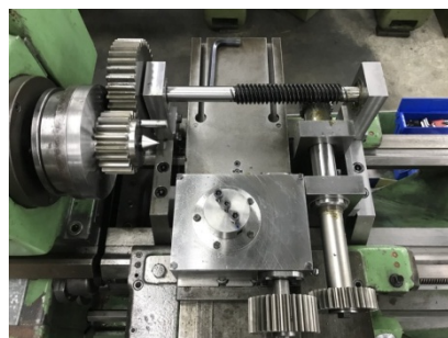
ภาพที่ 12 อุปกรณ์กึ่งเกลียวหนอนแบบดับเบิลเอนโวลูบ
