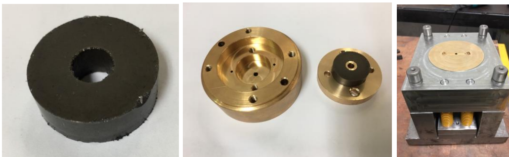
ภาพที่ 12 การประกอบแม่เหล็กเข้ากับแม่พิมพ์ฝังควิต
