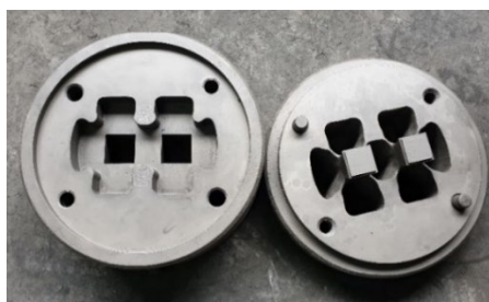
ภาพที่ 5 แม่พิมพ์อัดรีดร้อนแบบเดิมที่มีหนึ่งด้านของสี่เหลี่ยมหันเข้าหากัน
