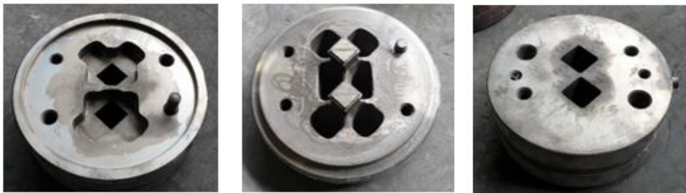
ภาพที่ 18 แม่พิมพ์อัดรีดร้อนแบบทแยงมุม 45 องศา
