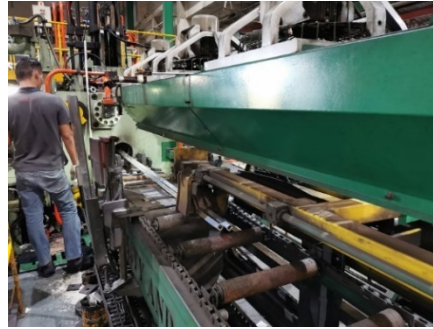
ภาพที่ 19 การอัดรีดชิ้นงานอลูมิเนียมโปรไฟล์ผ่านแม่พิมพ์ด้วยความเร็ว 5 มิลลิเมตร/วินาที
