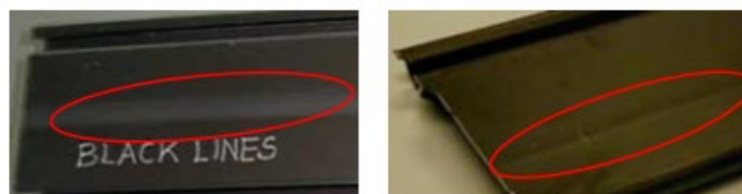
ภาพที่ 3 ปัญหา ทางขาว-ทางดำ ที่เกิดขึ้นบนผิวชิ้นงานอลูมิเนียมอัดรีดร้อน A.F.M.
