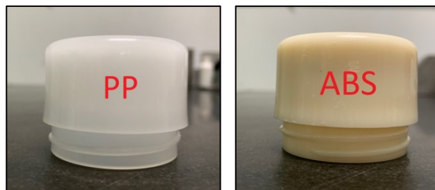
ภาพที่ 12 การยู่บตัวของพลาสติก (ซ้าย) PP เกรด 1100NK (ขวา) ABS เกรด GA800
