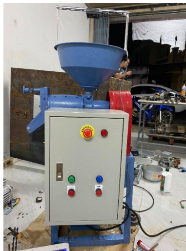
ภาพที่ 5 ติดตั้งตู้ควบคุมเข้ากับเครื่องสีเมล็ดกาแฟสั่งการโดยผ่านสมาร์ทโฟน
