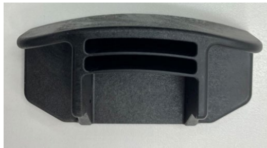
ภาพที่ 7 ชิ้นงานพลาสติกจากทดลองฉีดตามเงื่อนไขของทางอุทก
