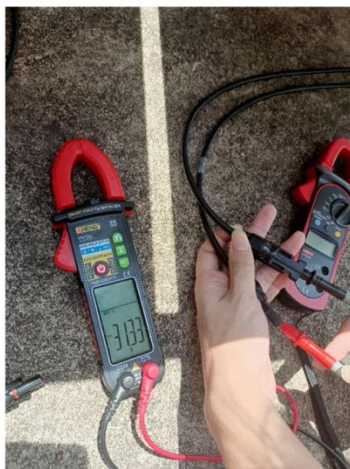
ภาพที่ 4 ตัวอย่างการวัดค่าแรงดันและกระแสของแผงเซลล์แสงอาทิตย์
