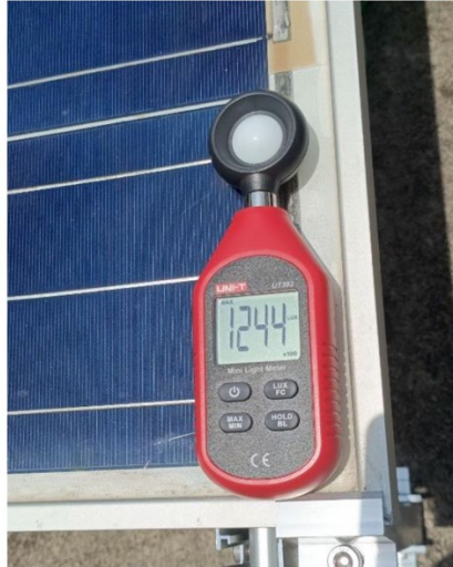
ภาพที่ 5 ตัวอย่างการวัดค่าความเข้มแสงของแผงเซลล์แสงอาทิตย์
