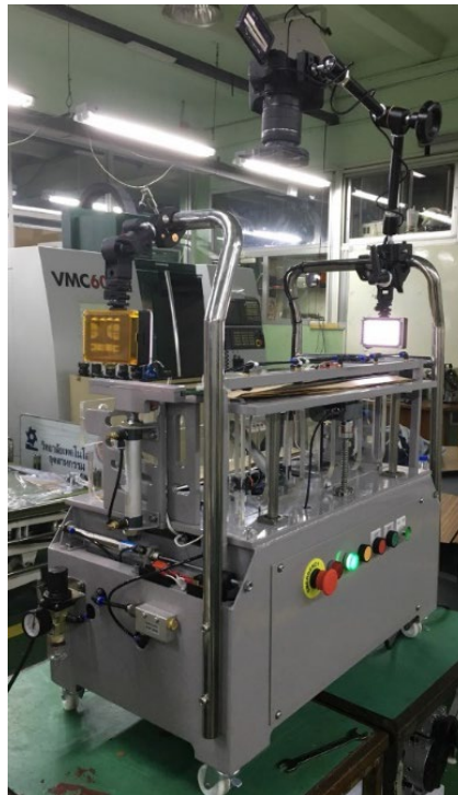
ภาพที่ 6 เครื่องจับยึดและพลิกคัมกร์ไบลานอัตโนมัติสำหรับการถ่ายภาพดิจิทัล
