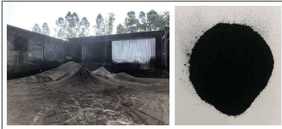
ภาพที่ 1 ผงฝุ่นคาร์บอนจากยางรถยนต์ที่ผ่านกระบวนการไพโรไลซิส
