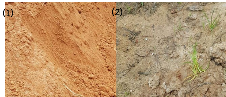
ภาพที่ 1 แสดงลักษณะของดินร่วนปนทราย สำหรับการทดลองการฝังกลบผ้า (1) ดินชนิด A (2) ดินชนิด B
