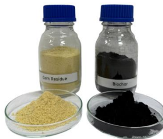
รูปที่ 2 แสดงผลิตภัณฑ์ไบโอชาร์จากกากข้าวโพดหวานที่ผ่านกระบวนการไพโรไลซิสในสภาวะที่เหมาะสม
