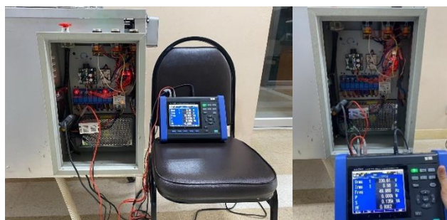
รูปที่ 5 แสดงการวัดค่าสัญญาณคุณภาพไฟฟ้าด้วยเครื่อง HIOKI รุ่น LR8401-20 (D)
