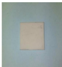
รูปที่ 3 แผ่นเซรามิกดินขาวที่ยังไม่ผ่านกระบวนการเคลือบ ที่มา : ผู้จัดทำ
