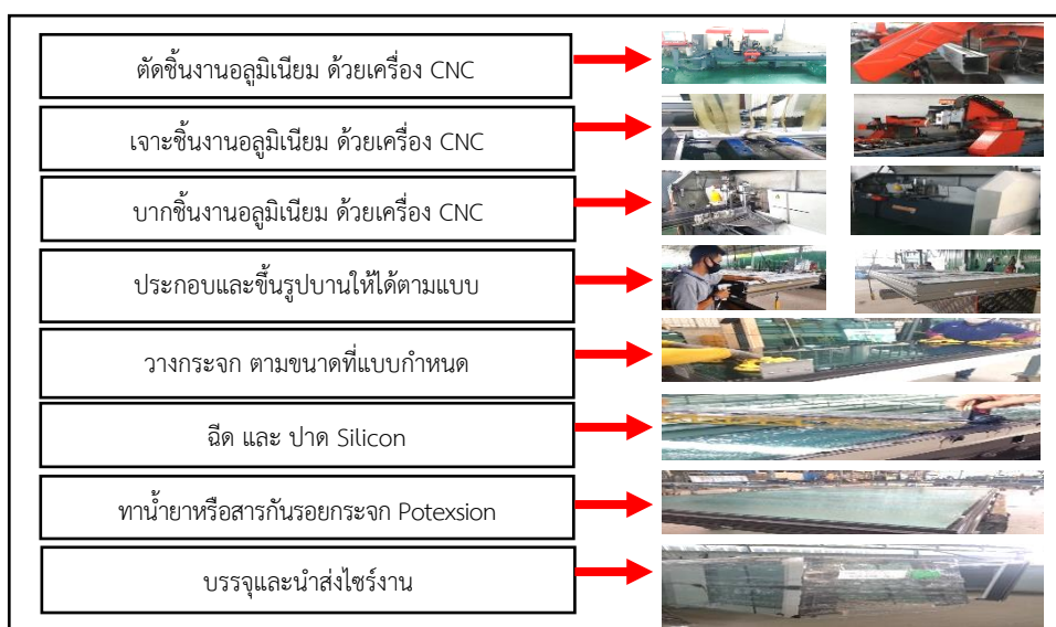
รูปที่ 3 กระบวนการผลิตกรอบกระจกอลูมิเนียม
